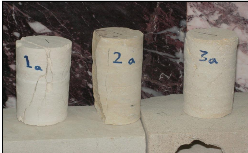
الشكل (2) الشقوق التي تظهر على النماذج بعد الفحص
