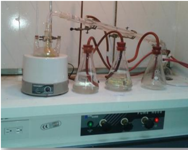
الشكل (1): منظومة التقطير المستخدمة في عملية الكربنة الأولية
